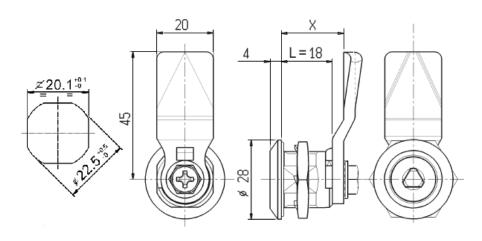
¼ tour droite ou gauche en zamak pour coffrets. Etanche à l'eau et à la poussière IP65. Entraînement de came par carré 8 mm. Fixation de la came par vis.
